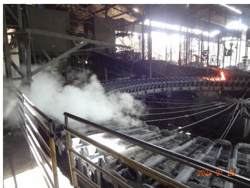
Foto 19: Aspersão de água para resfriamento da gusa. Esse efluente cai no chão do rodeo e escoar superficialmente para fora da estrutura e segue em direção ao tanque de sedimentação de efluente com grafite.
