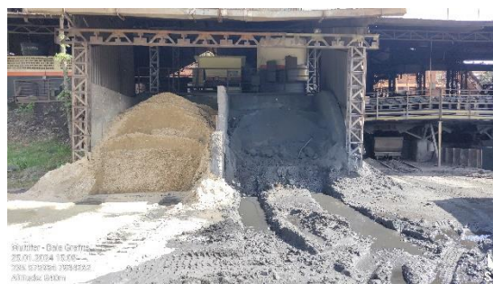
Foto 20: Estoque de grafite utilizado para cobrir as formas da gusa e a sílica para cobrir o canal que escoar a gusa do alto-forno até a bica para cair no rodeo.
