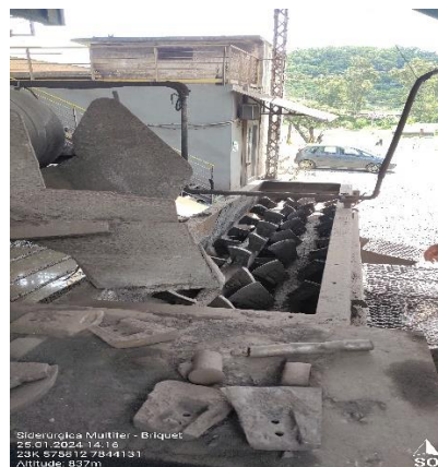
Foto 22: Misturador de insumos utilizados na fabricação de briquetes.
