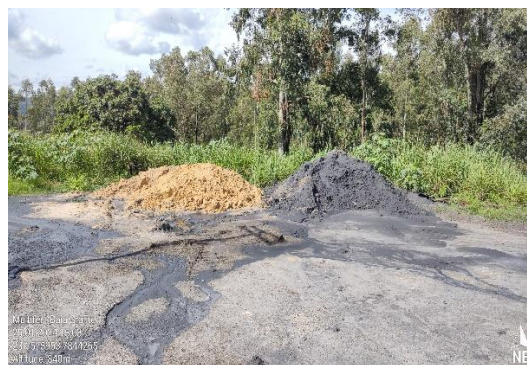
Foto 8: Parte do efluente com grafite escoando superficialmente em direção a bacia de sedimentação. Juntamente com este efluente escorre água de limpeza da área e de extravasamento da captação de água de resfriamento do alto-forno.
