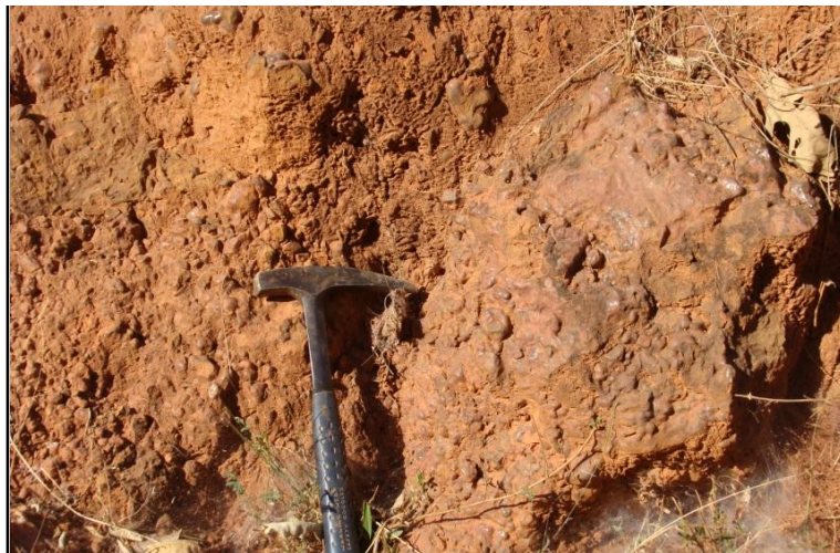
Foto 13. Blocos de carapaça detrítica com morfologia arredondada formada pelos agregados de óxidos.
