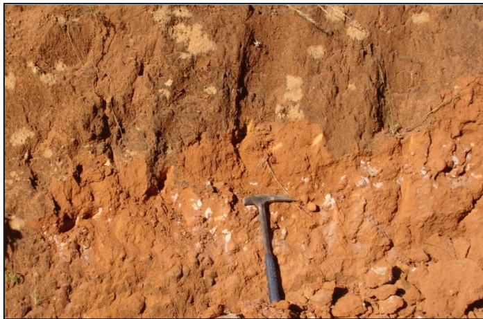
Foto 10. Arenito com intercalações centimétricas de níveis pelíticos.
