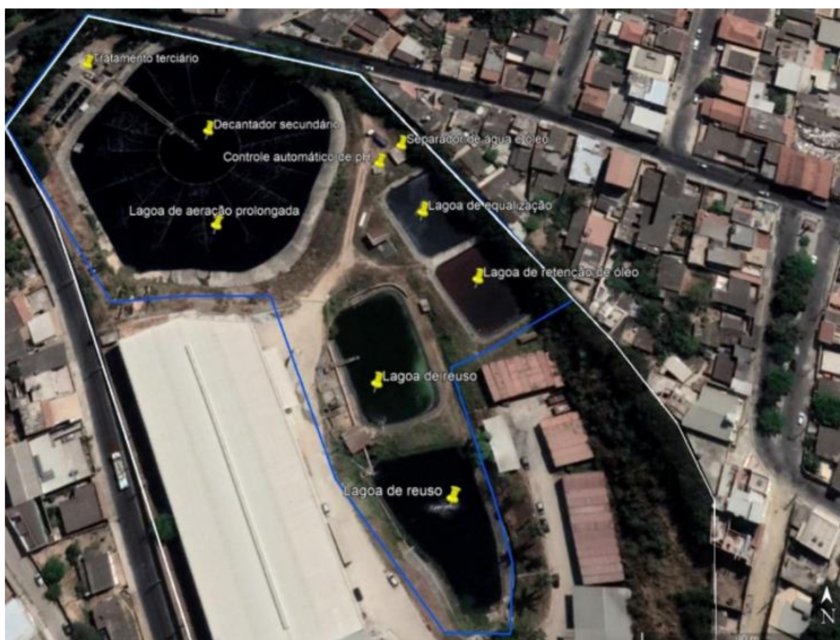
Figura 6.1.1: Identificação das operações unitárias da ETE instalada
