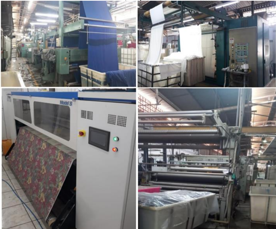
Figura 2.2.2. Equipamentos do Acabamento: Rama, Felpadeira, Impressora e Rama desativada, respectivamente.
