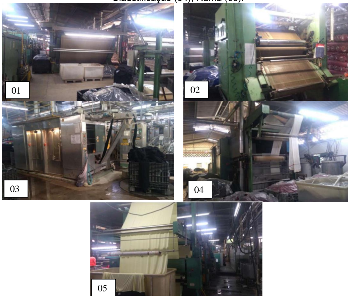
Figura 2.2.3. Equipamentos: Secadora (01), Calandra (02), Lavadora (03), Claustificação (04), Rama (05).
