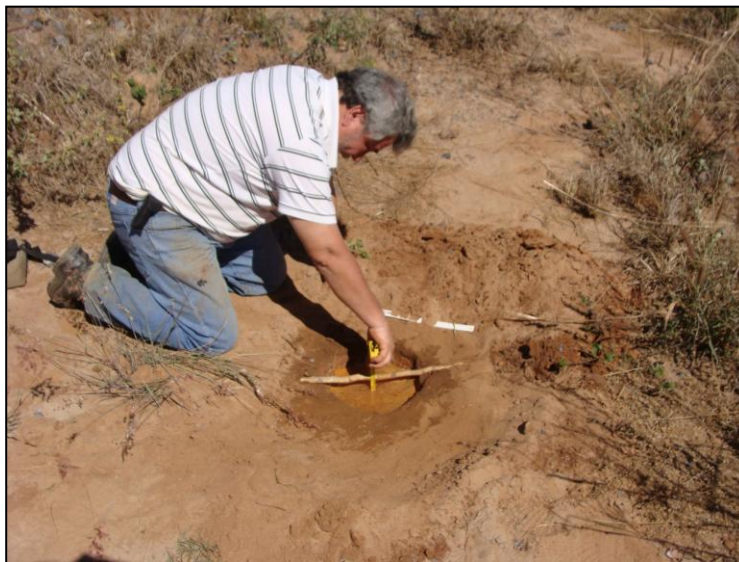
Foto 27 – Detalhe da execução do ensaio de infiltração em solo
