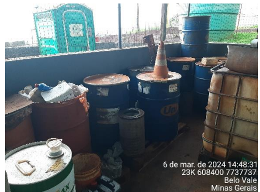
Foto 46: Armazenamento inadequado dos insumos e resíduos utilizados na oficina e lavador de veículos.
