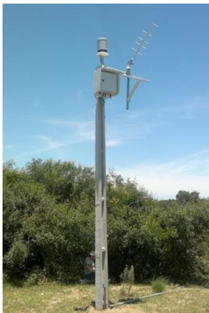
Figura 9: Instalação da PCD em poste alto, de concreto, na Estação Rosário do Sul, RS.
