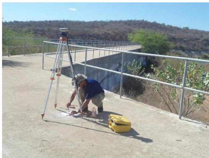
Figura 14 - Determinação altimétrica de uma RN da seção de régua dos corpos hídricos e dos pontos de afluência e defluência.
