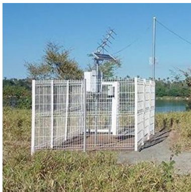
Figura 8: Instalação de PCD em um poste baixo e cercado por grade.
