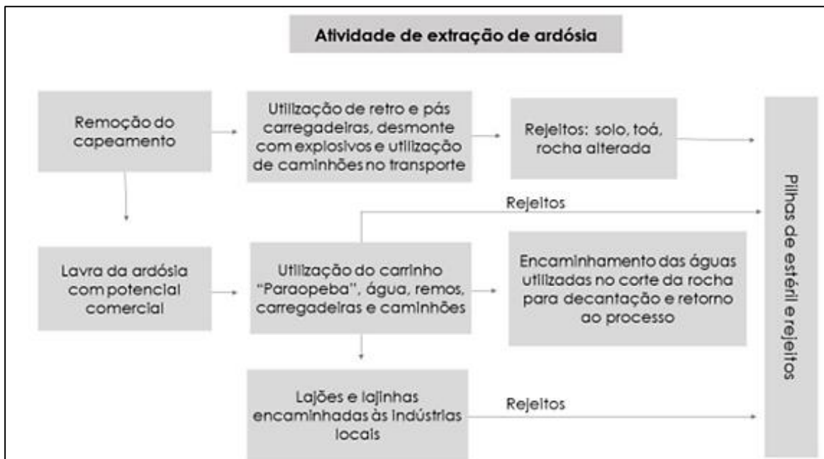
Figura 5. Fluxograma do processo de extração de ardósia.
