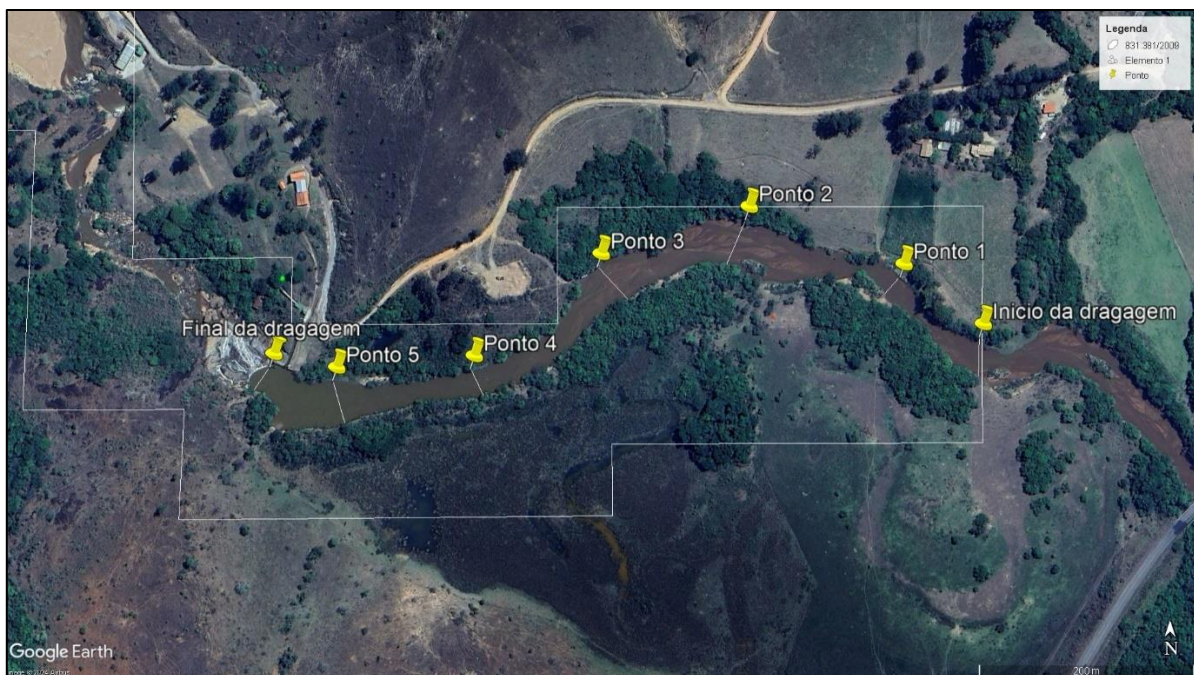
Figura 12 - Croqui das medições de largura do canal do rio Jacaré no trecho de dragagem.
