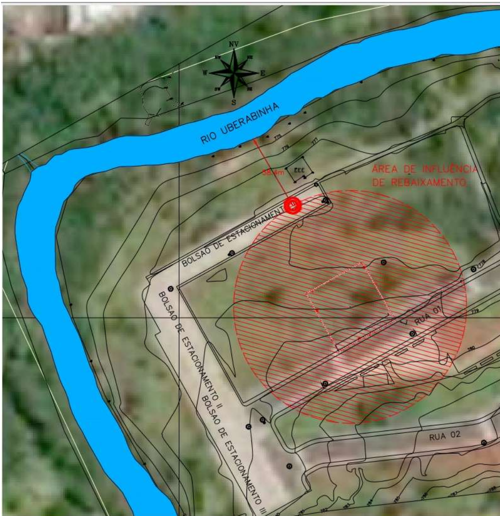
Figura 6. Sobreposição da área de influência do sistema de rebaixamento. Fonte: estudo apresentado.
