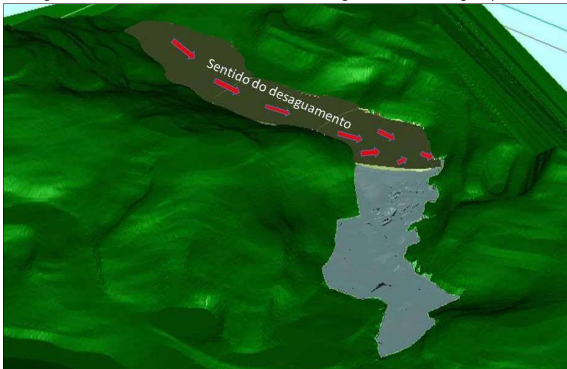
Figura 36 – Reservatório totalmente selado e com o gerenciamento de águas pluviais.
