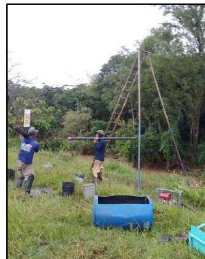
Figura 27 – Execução da sondagem SP-03 (Fonte: MCG Engenharia - RL-4710.04-6521-114-M9C-001).
