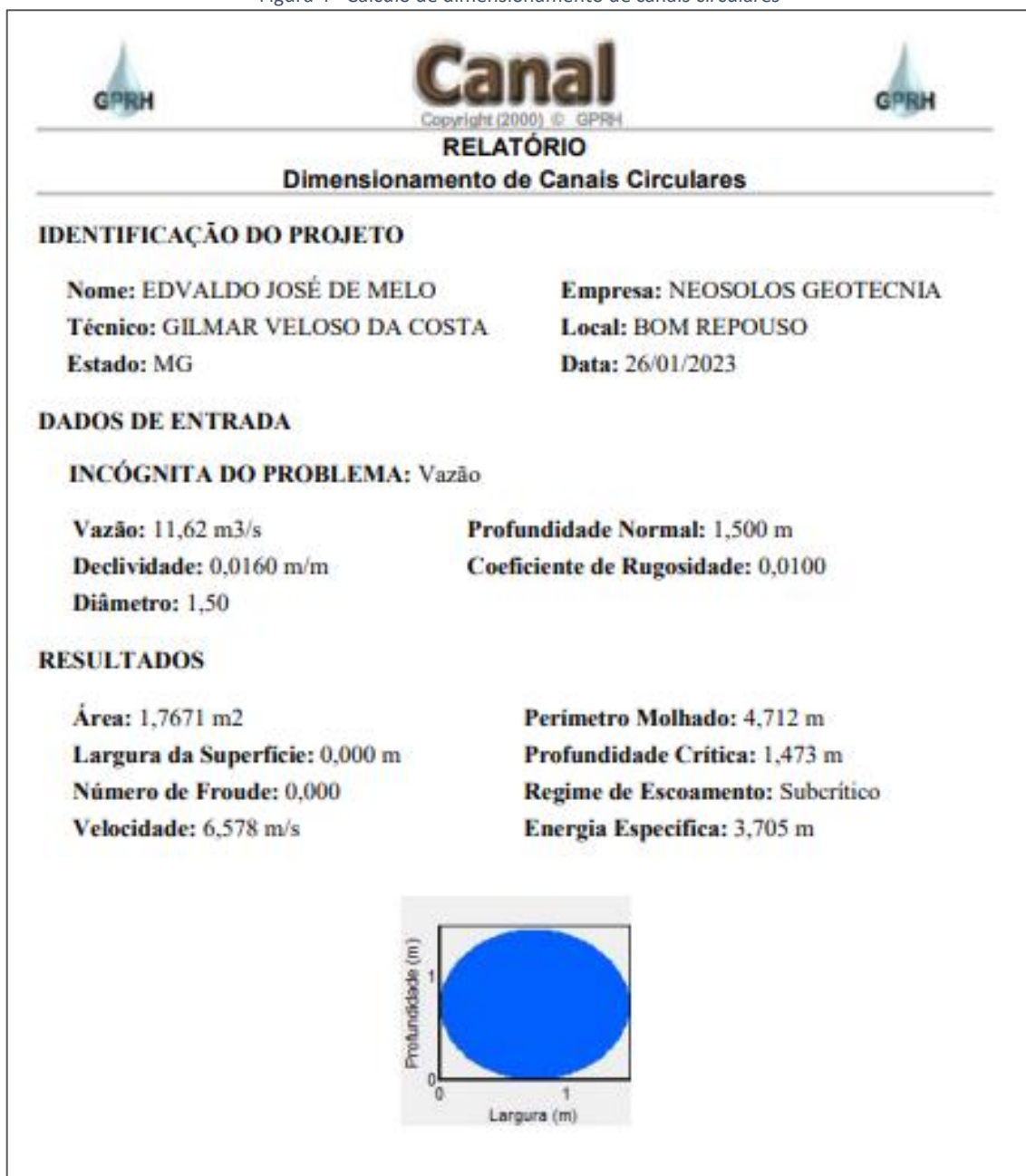
Figura 4 - Cálculo de dimensionamento de canais circulares
