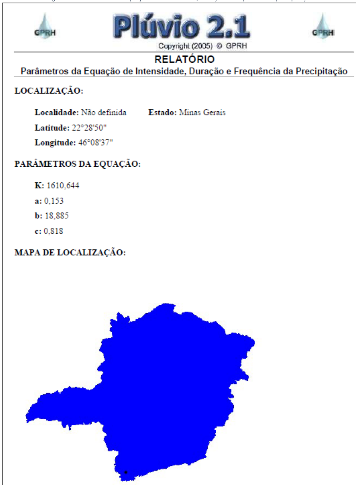
Figura 3 - Parâmetros da equação de intensidade, duração e frequência da precipitação
