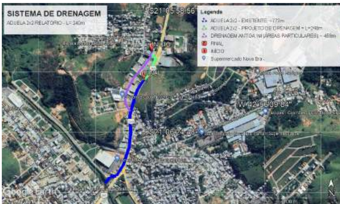
Figura 02- Imagem do Google Earth mostrando as aduelas e o corpo receptor - Ribeirão Ubá
