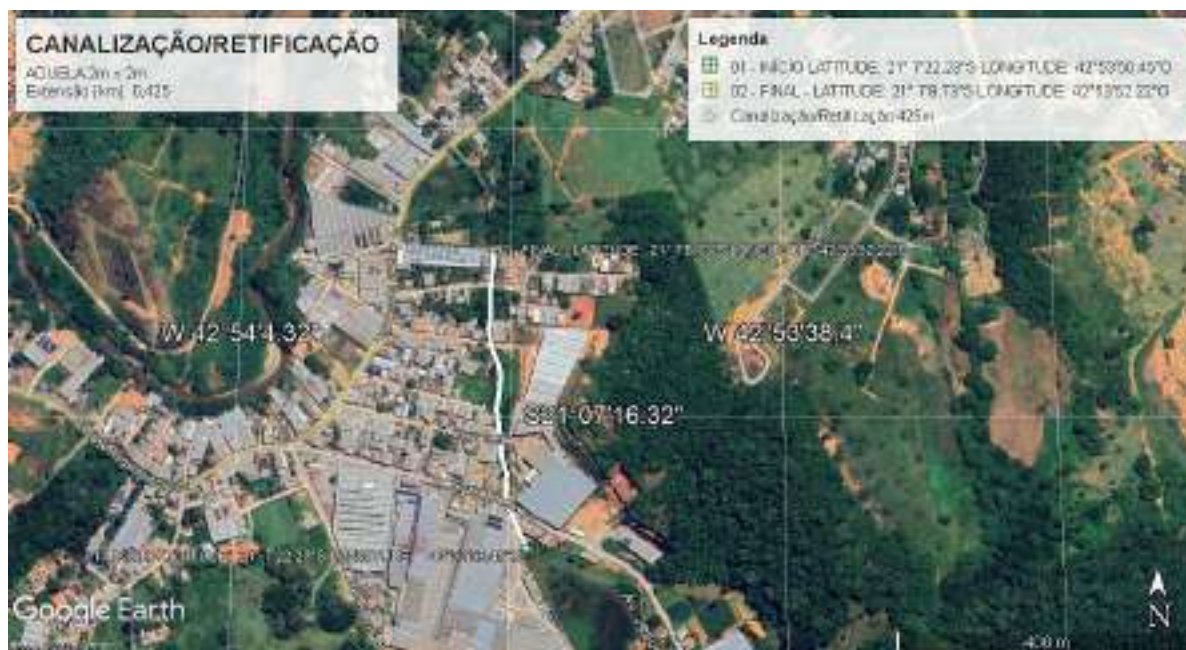
Figura 08 - Canalização/Retificação. Aduela (2m x 2m) Extensão= 0,425 km
