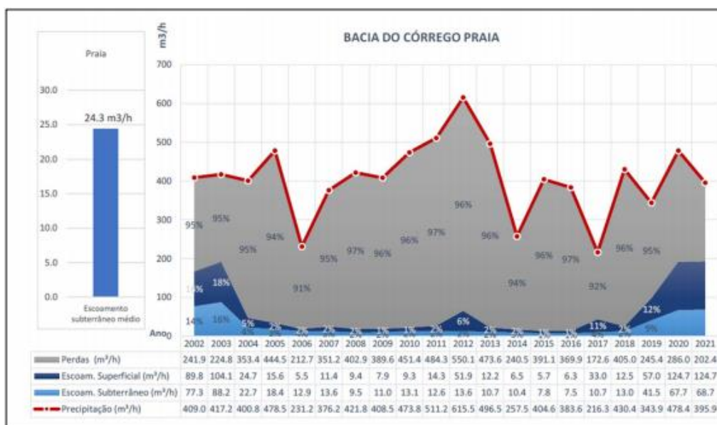
Figura 12: Hidrograma resultante do balanço hídrico da bacia do córrego Praia. Fonte: Hidrovia, 2022
