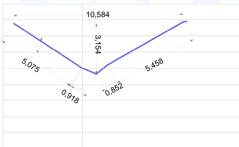
Figura 16 - Seção Tipo Natural do Canal à Montante
