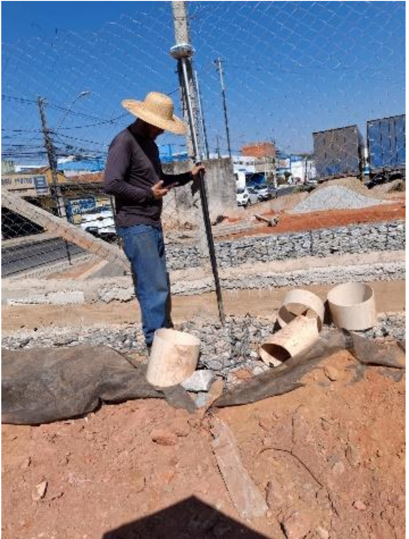
Figura 5 – Exemplo de coleta de dados com DGPS
