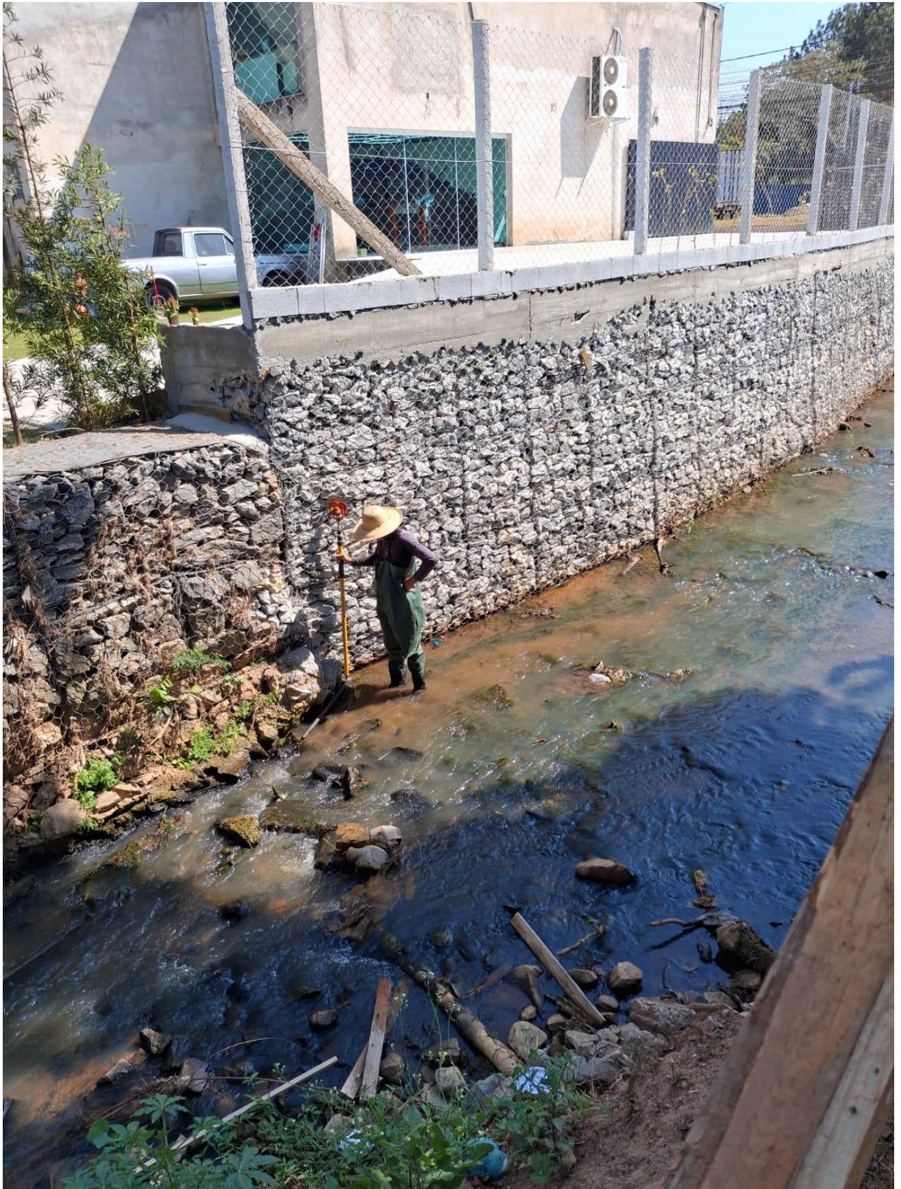
Figura 42 – Coleta de cota no fim do trecho
