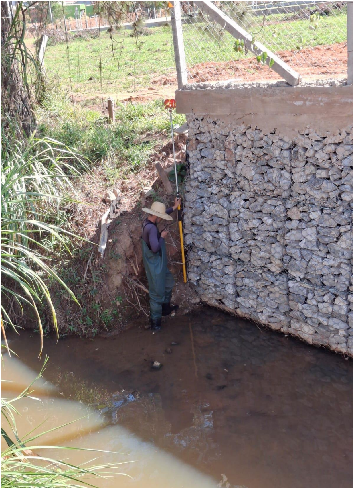
Figura 15 – Coleta de cota no início da margem esquerda
