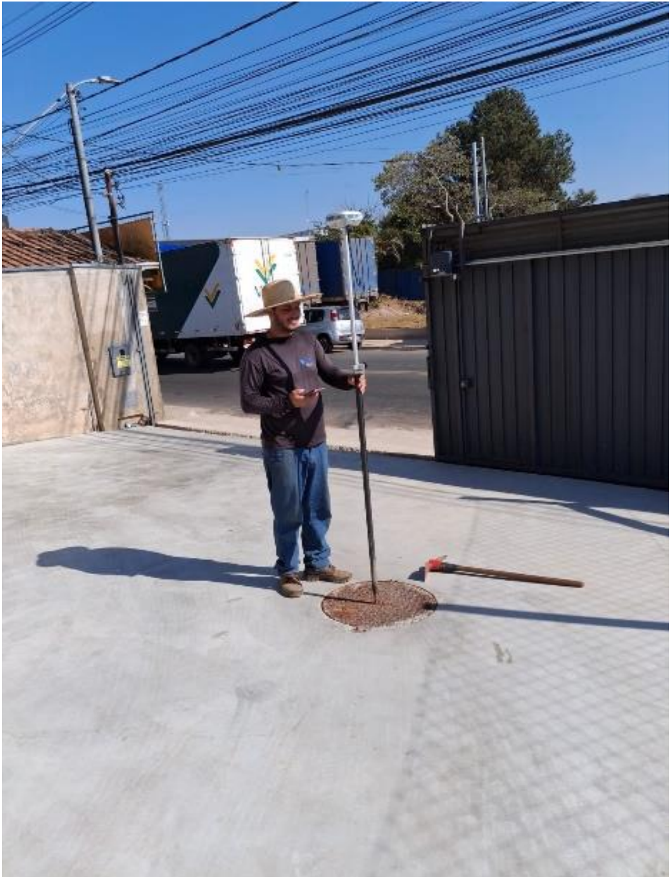
Figura 4 – Exemplo de coleta de dados com DGPS
