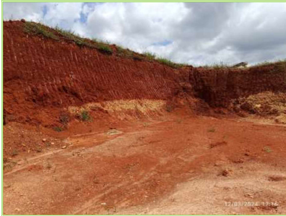
Foto 1: Colúvio derivado das rochas calcíticas que ocorrem na área do empreendimento e entorno. Ocorrência na porção central do empreendimento.
