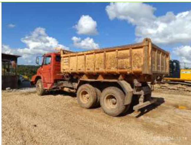
Foto 8: Modelo de caminhão basculante utilizado no empreendimento para transporte do material lavrado.
