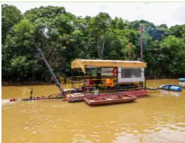
Foto 7: Modelo similar de balsa a ser utilizado no empreendimento para dragagem de areia.
