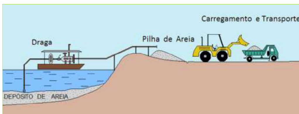
Figura 8: Representação esquemática do processo de lavra de areia por dragagem em balsa.
