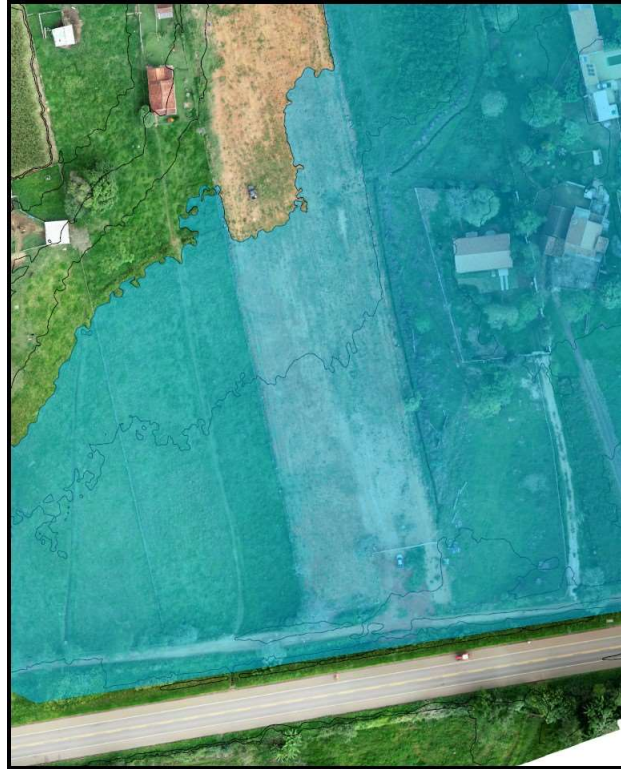
FIGURA – 37: PLANTA BAIXA SOBREPOSTA A ORTOFOTO ILUSTRANDO A SIMULAÇÃO DE CHEIAS NO LOCAL SEM A INTERVENÇÃO
