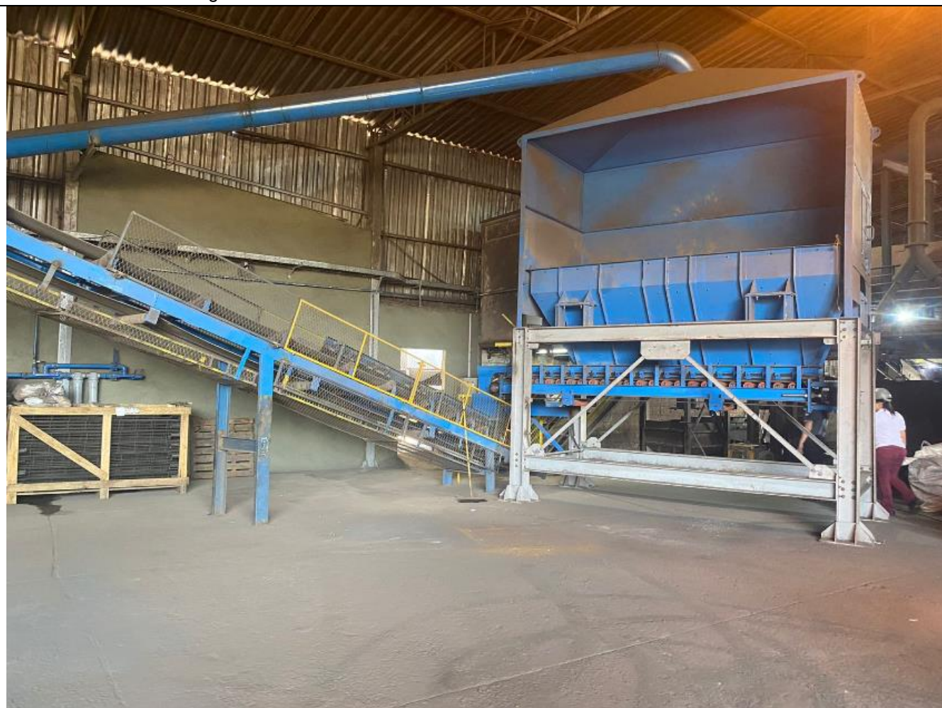
Figura 1. Silo alimentador e correia transportadora.
