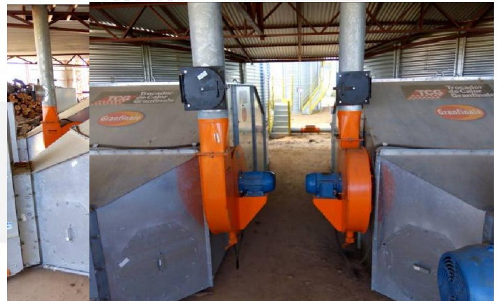
Foto 04. Filtros catalisadores nos secadores de grãos.
