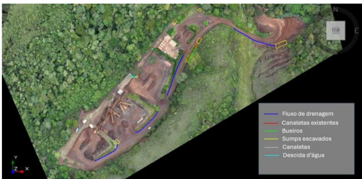
Imagem 05: Sistema de drenagem
