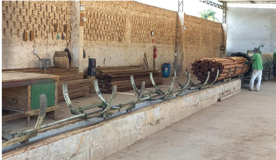
Foto 02. Autoclave, fosso, e remoção da madeira tratada---
