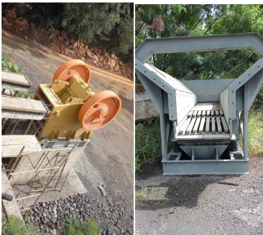
Foto 1- Equipamentos em instalação para ampliação da britagem (marrueiro e calha vibratória).
