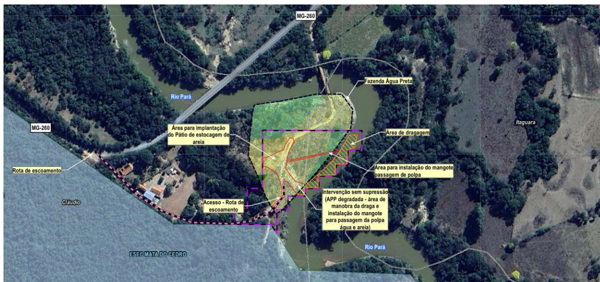
Figura 01: Área Diretamente Afetada (vermelho), Área de Dragagem (amarelo), Poligonal ANM (roxo). Fonte: RAS
