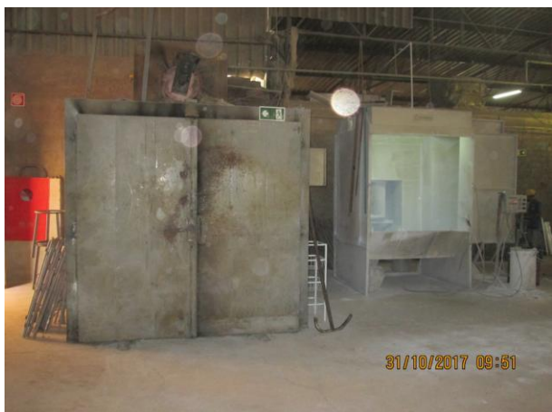
Cabine de pintura a seco e estufa de secagem
