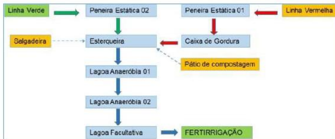
Figura 02. Fluxograma do Processo Produtivo. Retirado dos estudos apresentados.
