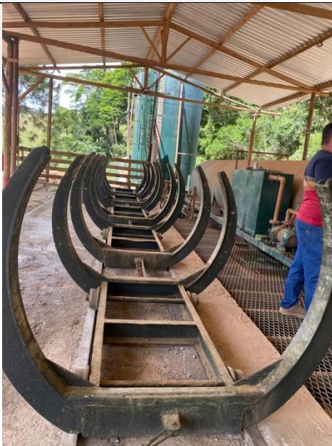
Foto 03 – Vagonetas na área de respingo impermeabilizada.
