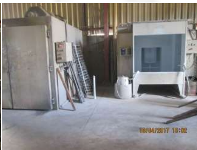
Figura 04: Estufa de secagem e cabine de pintura eletrostática.
