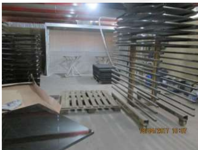
Figura 01: Cabine de pintura a seco.
