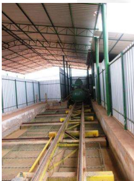
Figura 2 – Autoclave instalada em ambiente abrigado e sobre uma bacia de contenção
