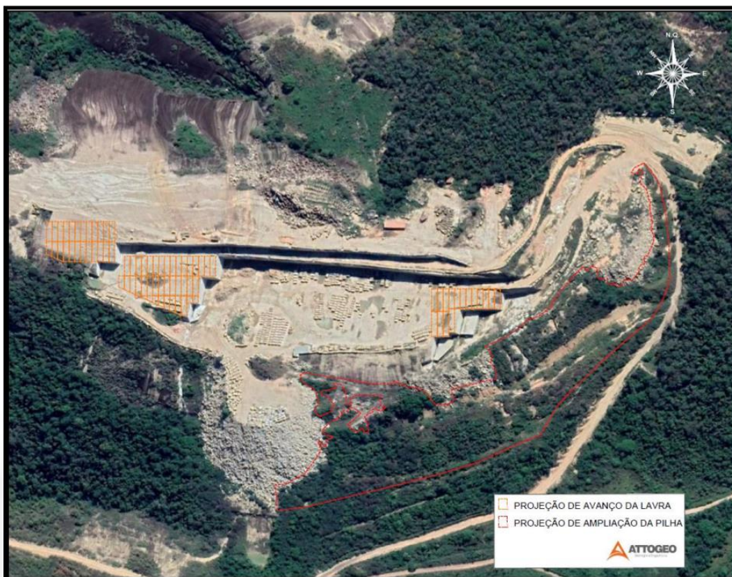
Figura 2. Projeção do avanço da frente de lavra e área de expansão da Pilha de Rejeito 05. Fonte: Resposta Informações complementares – IC 1_EIA/ RIMA/ PCA Attogeo – 2022.
