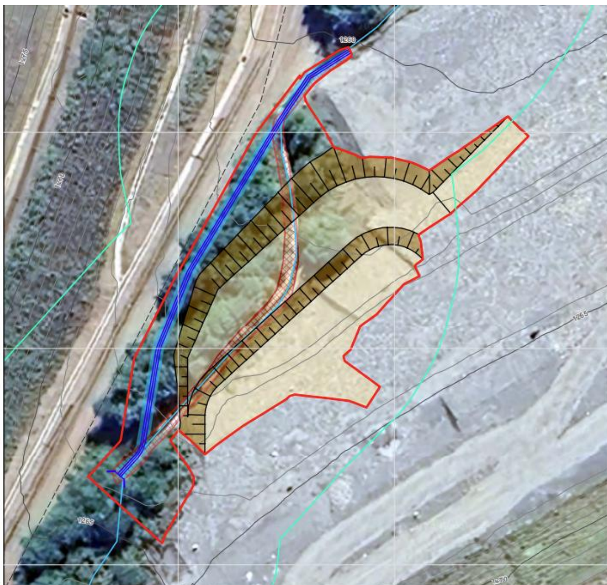
Figura 3: Reforço das bermas no setor 17 da ARB3. Fonte: RCA.
