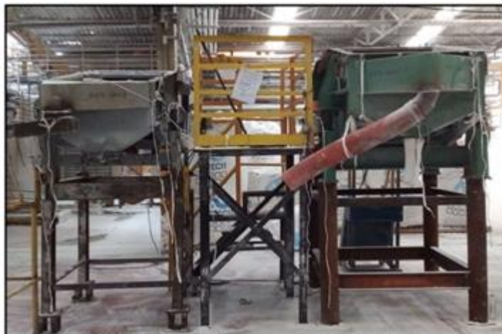
Figura 6 - Peneiras utilizadas para a separação alumina/chamote. Fonte: Evidência do cumprimento do Cronograma do Plano de Ação / Melhorias de 25/04/2023 (SEI 64778651).
