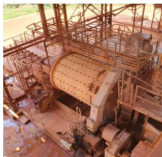
B- Moinho de Barras Utilizado na Moagem da Bauxita
