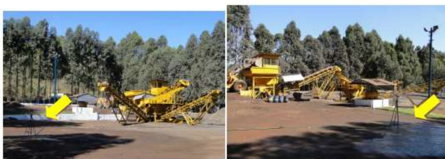
Figura 05: Aspersão periódica da planta de beneficiamento de rejeitos de minério
