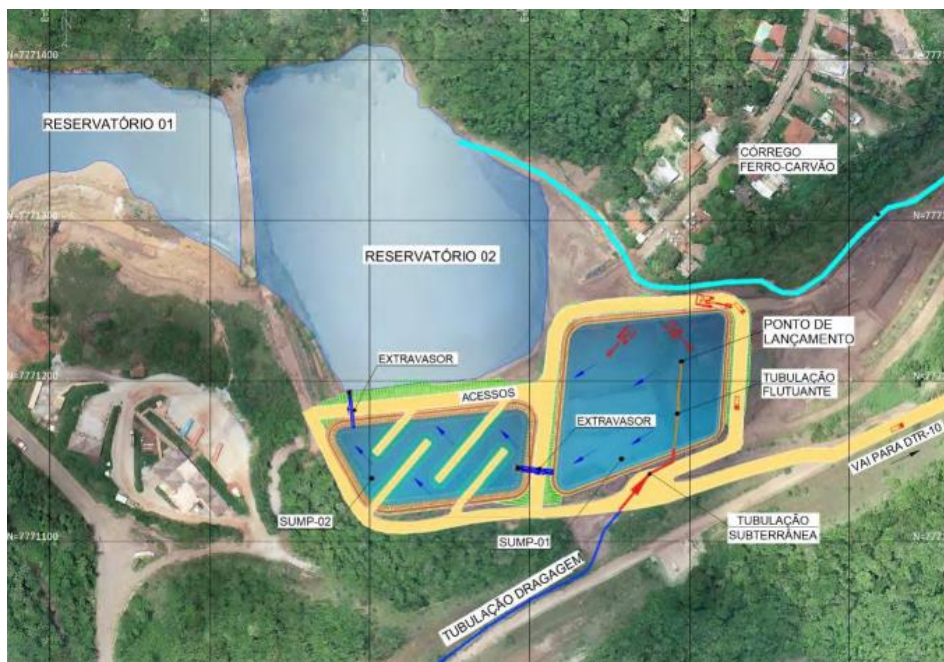
Figura 18 - Detalhe das contribuições da EP-01: córrego Ferro-Carvão e sumps de dragagem (sump- 01 e sump-02). Fonte: PCIA Projetos Diversos, Vale 2024.
