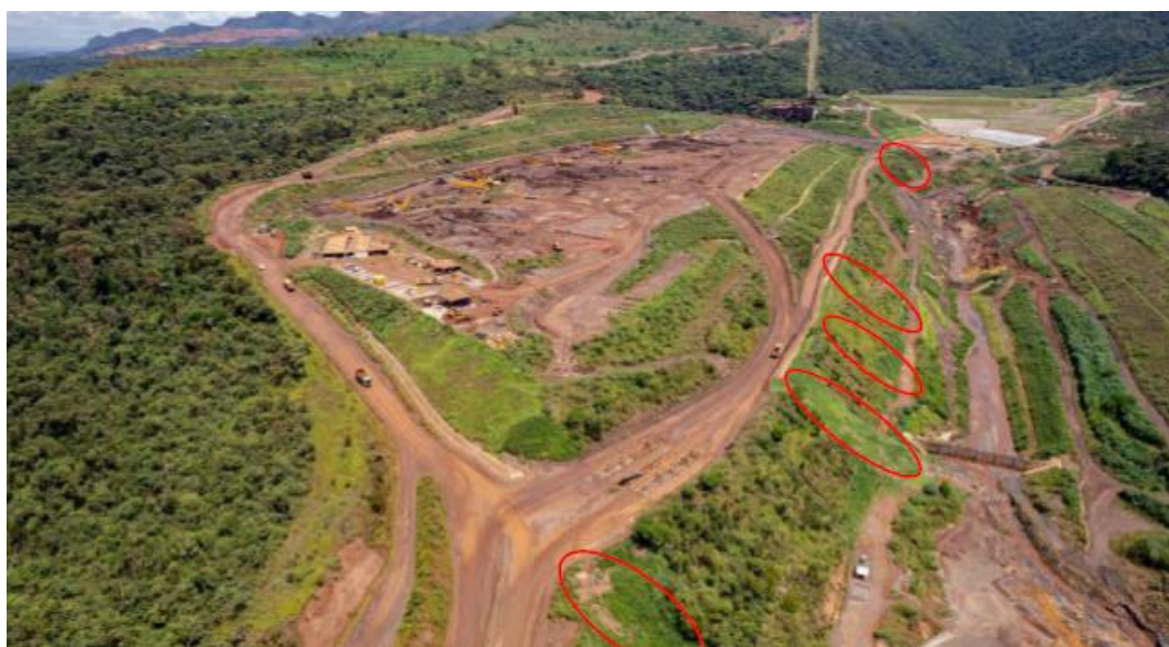
Figura 15 - Pontos destacados em vermelho onde as erosões foram tratadas na região do talude do TCF. Fonte: PIA dos Projetos implantados em caráter emergencial, Vale, 2024.
