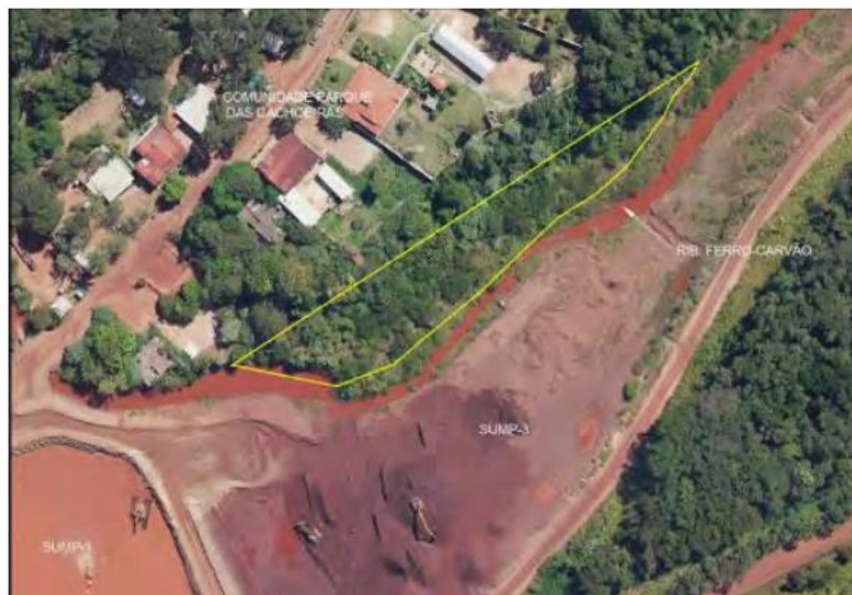
Figura 19 - Sumps de dragagem a montante do reservatório da EP-01, com destaque para a poligonal, em amarelo, à esquerda do sump-03. Fonte: PCIA Projetos Diversos, Vale 2024.
