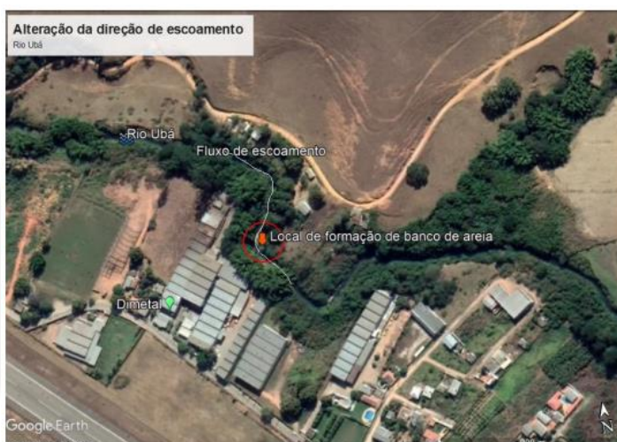
Figura 4. Detalhe da alteração de direção do escoamento do Rio Ubá e destaque do ponto de formação de bancos de areia (Fonte: Google Earth, 2019)
