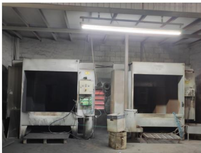
Figura 5: Cabines de pintura eletrostática.
