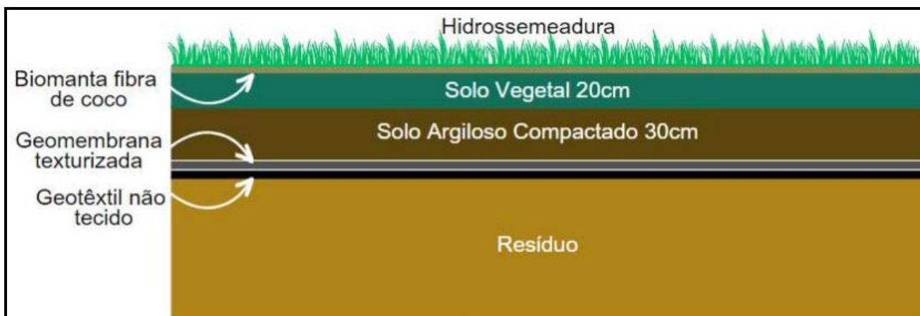
Imagem 14: Detalhamento do cobrimento dos taludes e cristas.
