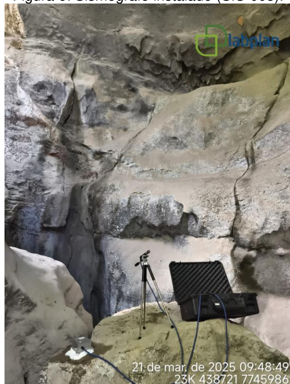
Figura 6: Sismógrafo instalado (SIS-003).
