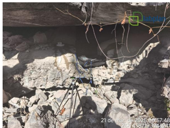
Figura 6: Sismógrafo instalado (SIS-003).
