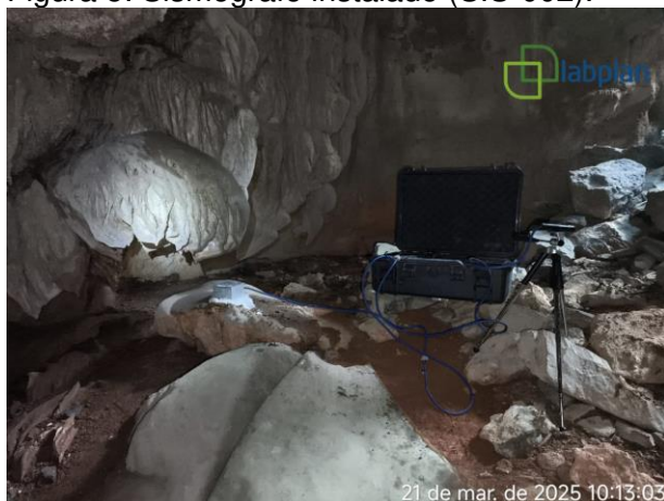
Figura 5: Sismógrafo instalado (SIS-002).
