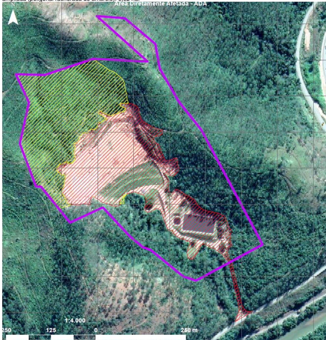
Figura 02: Área total do Aterro (poligonal rosa): 25,66 ha, ADA atual (poligonal rachurada de vermelho): 8,42 ha, ADA a ser ampliada (poligonal rachurada de amarelo): 6,62 ha.
