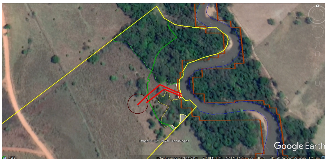
Figura 1. Área de preservação permanente do imóvel delimitada em verde claro, com áreas de compensação ambiental delimitadas em branco, áreas de intervenção ambiental demonstradas pelas tubulações em linhas vermelhas. Fora das áreas de preservação permanente está o pátio delimitado em marrom, a poligonal da ANM em marrom claro e o curso d'água em azul.
