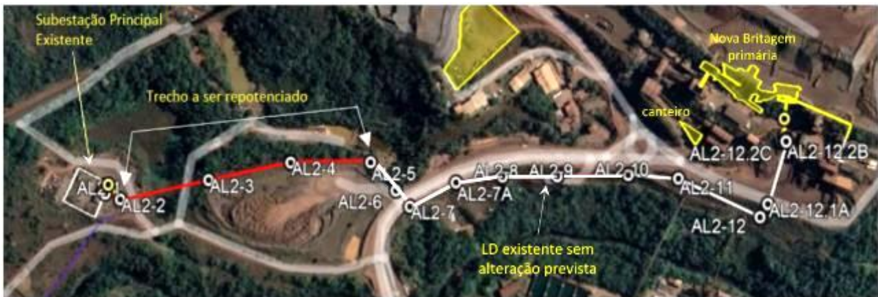
Figura 14. Trecho da LD existente que será repotenciado para alimentar a nova subestação elétrica.
