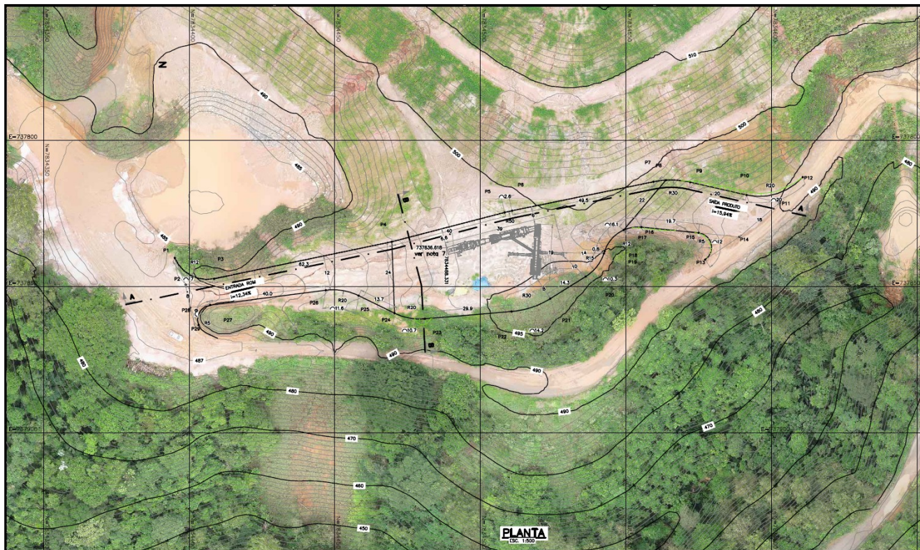
Figura 7: Arranjo geral da UTM a seco sobre a Pilha de rejeito/Estéril Sul.
