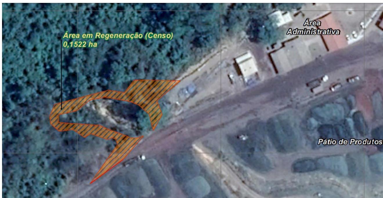
Figura 4: Área intervinda para obras emergenciais de contenção da voçoroca.
