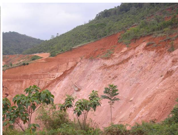
Foto 03 e 04: Decapeamento da Lavra Subterrânea, taludes danificados.
