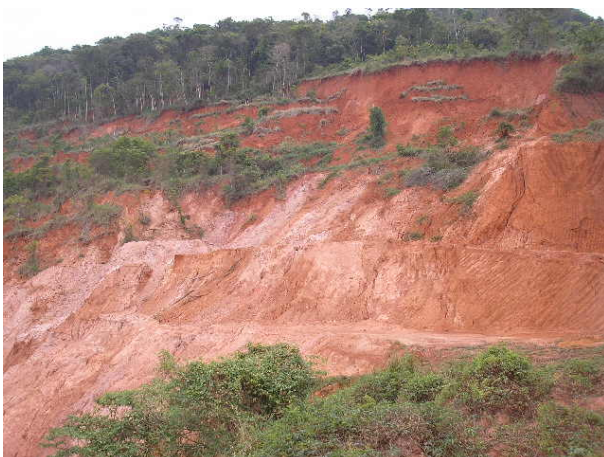
Foto 03 e 04: Decapeamento da Lavra Subterrânea, taludes danificados.
