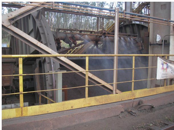
Foto 01: Car Dumper descarregando a matéria prima.
