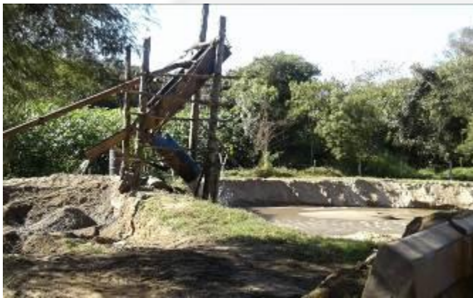
Foto 01. Propriedade Sítio Dona Lourdes, poligonal do DNPM nº 831.641/1997, com medidas mitigadoras (bacia de decantação e caixa tri compartimentada) já instaladas.
