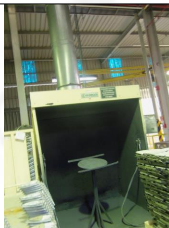
Figura 14a. Sistema de controle de emissões atmosféricas (cabine de pintura)
