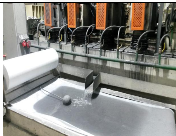
Figura 07. Sistema de retenção de partículas finas de alumínio
