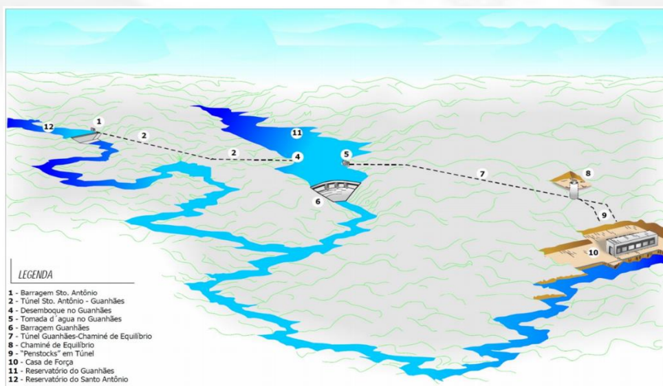
Figura 2: Layout do empreendimento. Fonte: EIA UHE Salto Grande - CEMIG, BRANDT Meio Ambiente, 2019.
