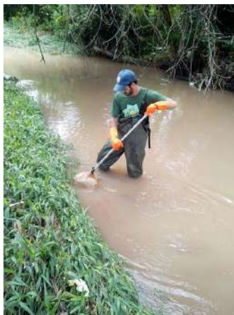
Figura 156 – Coleta de macroinvertebrados bentônicos com amostrador do tipo rede D, ponto de coleta #04 (C. Água Suja), APA Vargem das Flores
