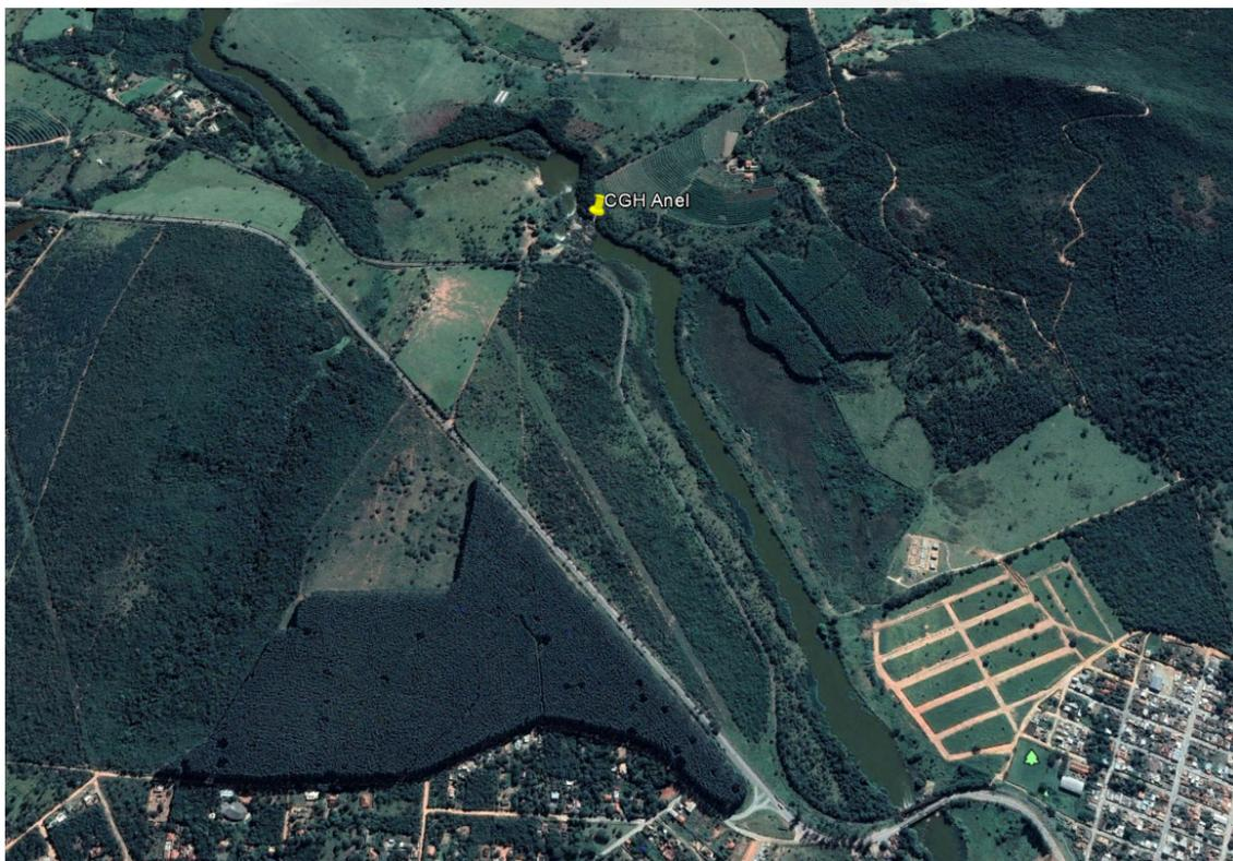
A potência instalada do empreendimento é inferior a 1 MW, desta forma o mesmo enquadra-se em Central Geradora Hidrelétrica – CGH. O arranjo geral da CGH representa um típico aproveitamento de geração de energia hidrelétrica por derivações de vazões. Para tanto, foi construído uma soleira (barragem) vertente de concreto, apresentando o circuito de geração na ombreira esquerda do Rio Pará.
