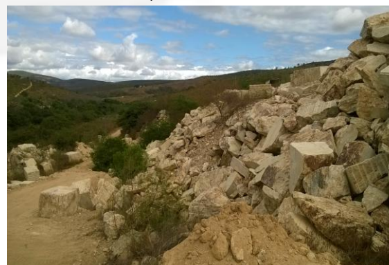
Foto 6. Pilha de rejeito/estéril.
